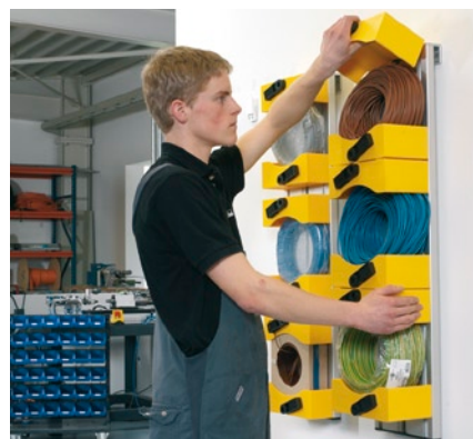
Fot. 7. Regał do przechowywania przewodów w wiązkach
