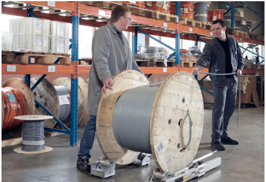
Fot. 2. Dwuczęściowy stojak do obsługi cięższych bębnow kablowych.
