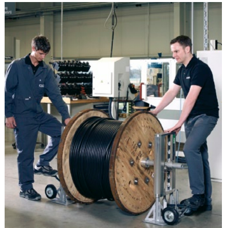
Fot. 3. Stojak do obsługi bębna o wadze do 4000 kg i średnicy 650-1600 mm.
