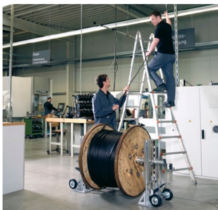
Fot. 4. Stojak do obsługi bębna o wadze do 6000 kg i średnicy 700-2200 mm.
